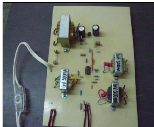
Figura 30.- Tarjeta de medición de voltajes trifásicos.
