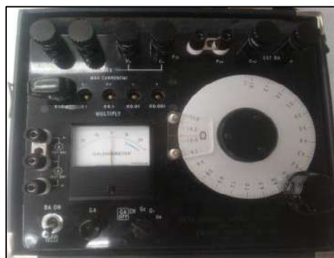
Figura 72.- Puente de Kelvin utilizado.
