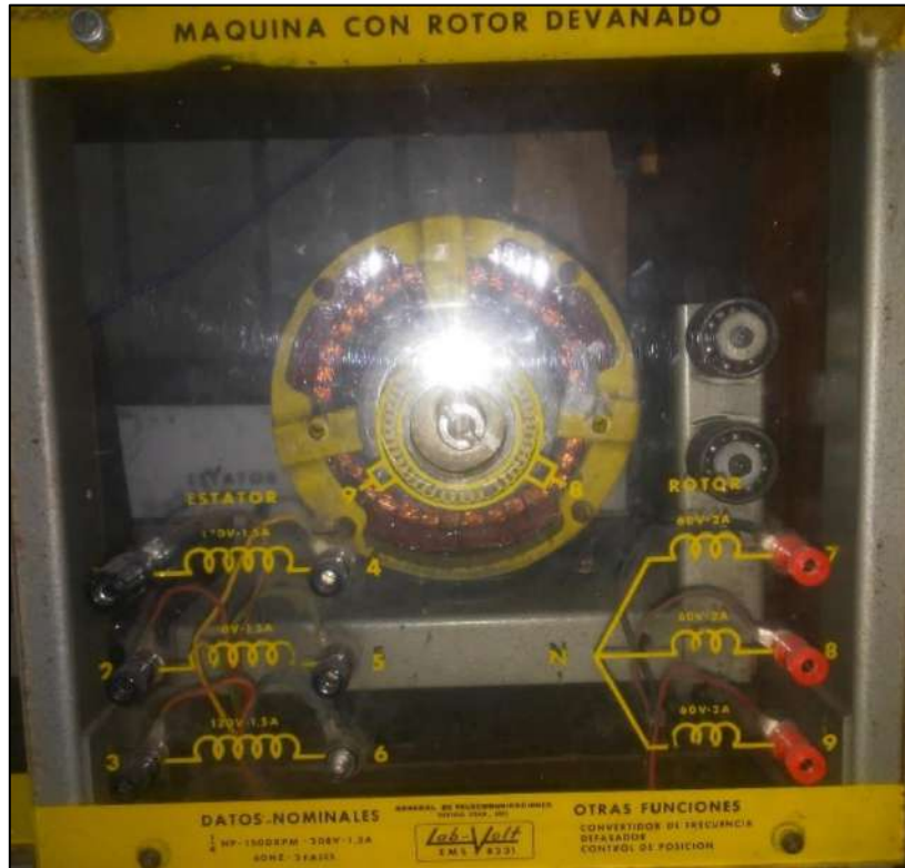
Figura 24.- Máquina de inducción de rotor devanado utilizada en el banco de pruebas.
