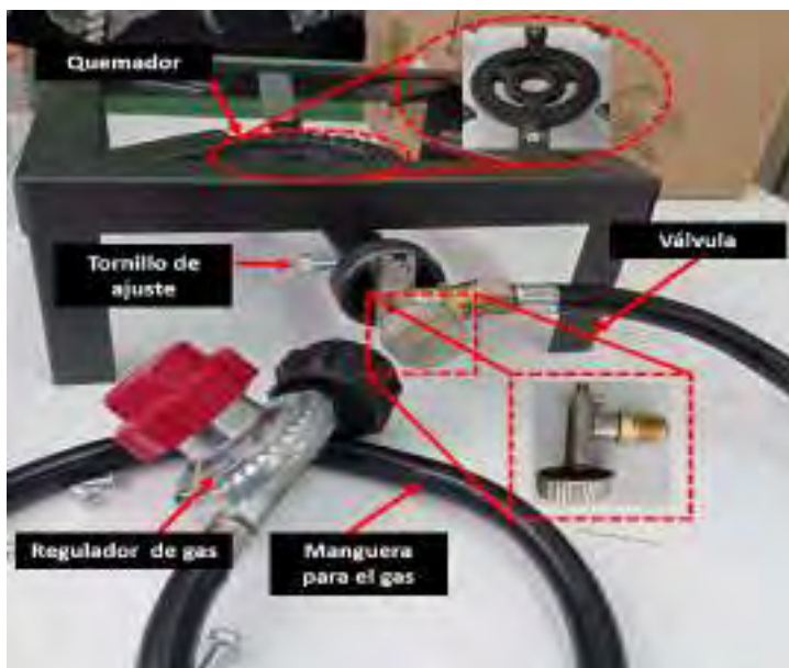
Fig. 2.23. Partes de la fuente de calor.
