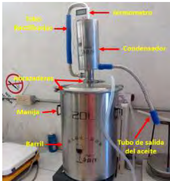
Fig. 2.15. Elementos de un destilador.
