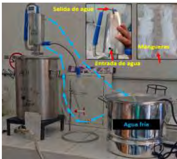
Fig. 2.21. Sistema de enfriamiento.
