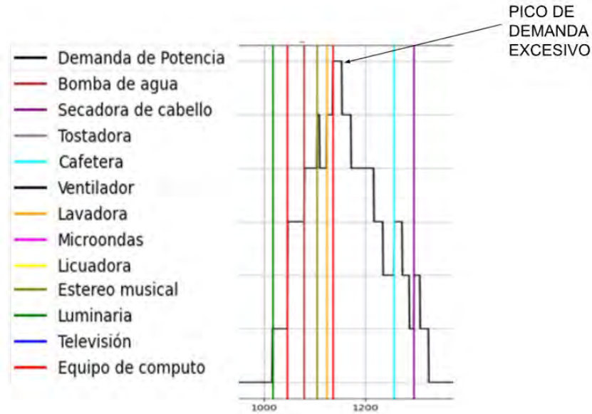
Figura 4.4 Pico de demanda que excede el suministro base del sistema de distribución ampliación de un segmento en la Figura 4. 3
