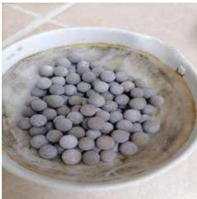
Figura 3.1.6 Soporte después del secado (10% de plata)
