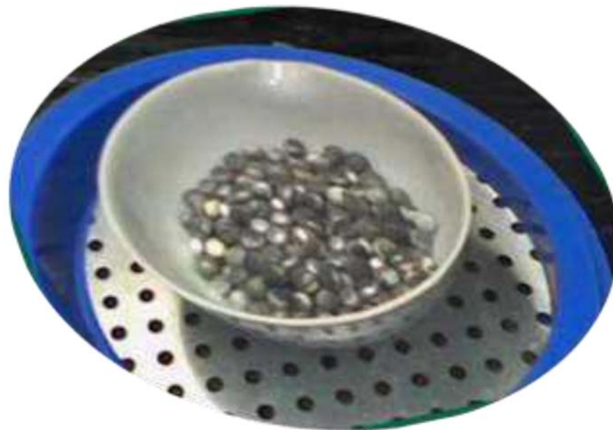
Figura 3.1.8. Catalizador después del calcinado (10% en plata)
