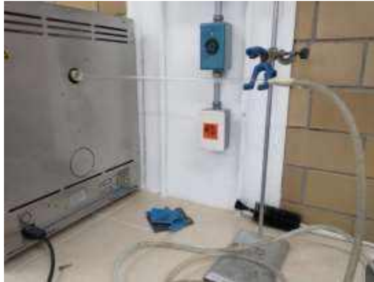
Figura 3.1.7 Conexión de aire en la mufla para la calcinación
