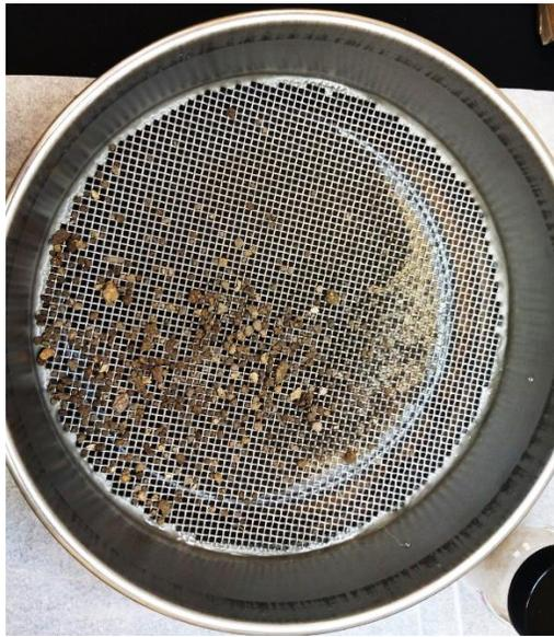
**Figura. 91. Criba con un tamaño de malla de 2 mm, en donde no se aprecia fragmentos del material de referencia (celulosa).**
