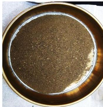
**Figura. 92. Tamaño de partícula de composta < 2 mm de la muestra de referencia (celulosa).**
