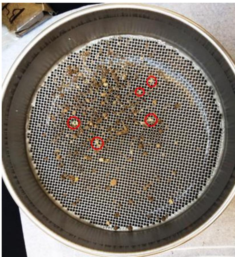
**Figura. 88. Criba con un tamaño de malla de 2 mm, en donde en los círculos rojos se muestra los fragmentos de la bolsa B5.**
