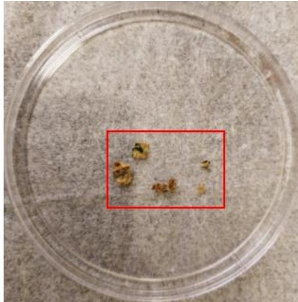
**Figura. 89. Residuo recuperado del proceso de tamizado, malla 2 mm de la muestra de bolsa B5.**
