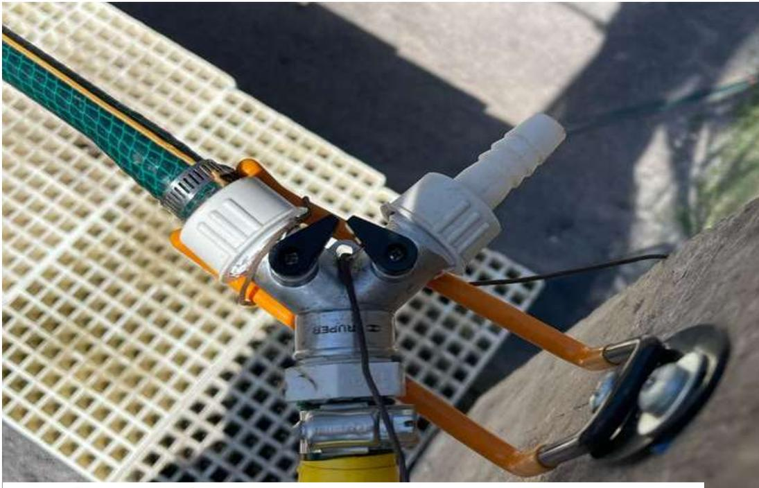
ILUSTRACIÓN 27 INSTALACIÓN DE SISTEMA DE RIEGO EL CUAL CONSTA DE UNA LLAVE TIPO V LA CUAL CONSTA CON DOS SALIDAS Y CADA UNA DE ELLAS TIENE SU LLAVE DE PASO UTILIZANDO MANGUERA DE MEDIA PULGADA Y 34 ASPERSORES.
