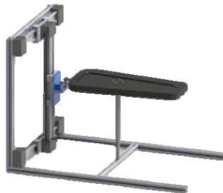
Figura 1-2: Mecanismo para rehabilitación de tobillo basado en una mesa XY [1].
