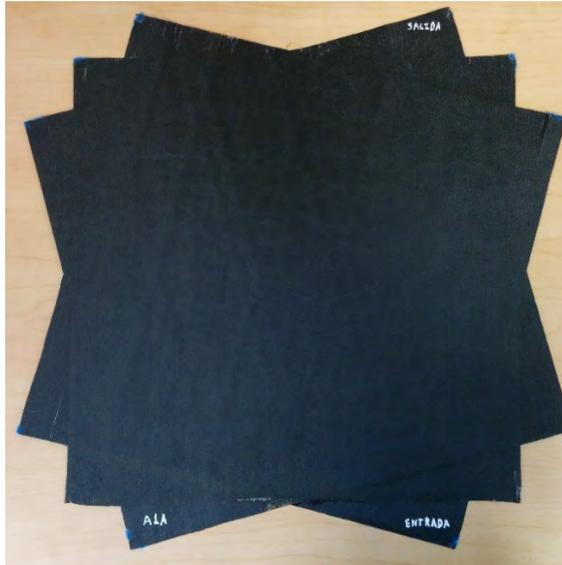
Figura 4.27 Laminado A1A [0/+15/-15]s en su estado final, en el cual se indica la dirección de entrada y salida de la resina.
