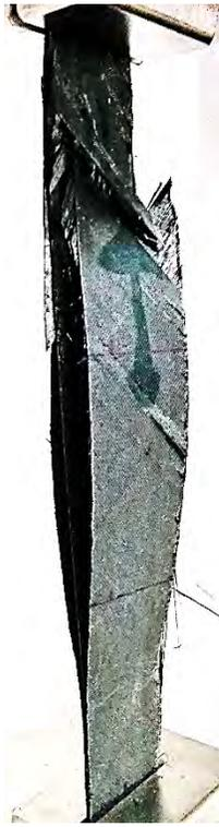
Figura C-7.3 Probeta B3A2 después del ensayo de tensión.
