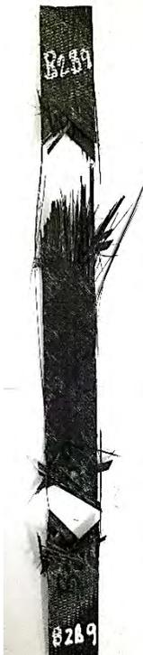
Figura C-6.5 Probeta B2B9 después del ensayo de tensión.
