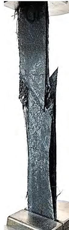
Figura C-7.4 Probeta B3A3 después del ensayo de tensión.
