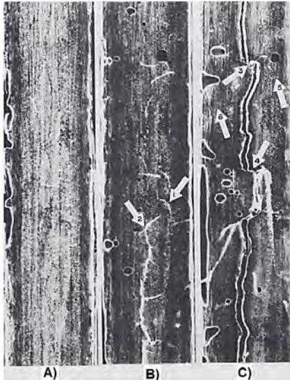
Figura 2.16 Fotomicrografías de la réplica del borde del laminado  $[0/\pm 45/90]_S$ , desarrollada en una prueba de fatiga tensión-tensión ( $R=1$ ): a) réplica del borde antes de iniciar las pruebas, b) réplica del borde a 50 ciclos, c) réplica del borde a 10,000 ciclos [30].
