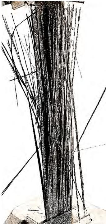
Figura C-9.5 Probeta CIA7 después del ensayo de tensión.
