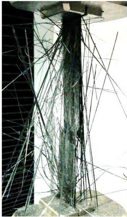
Figura C-4.3 Probeta BIA1 después del ensayo de tensión.
