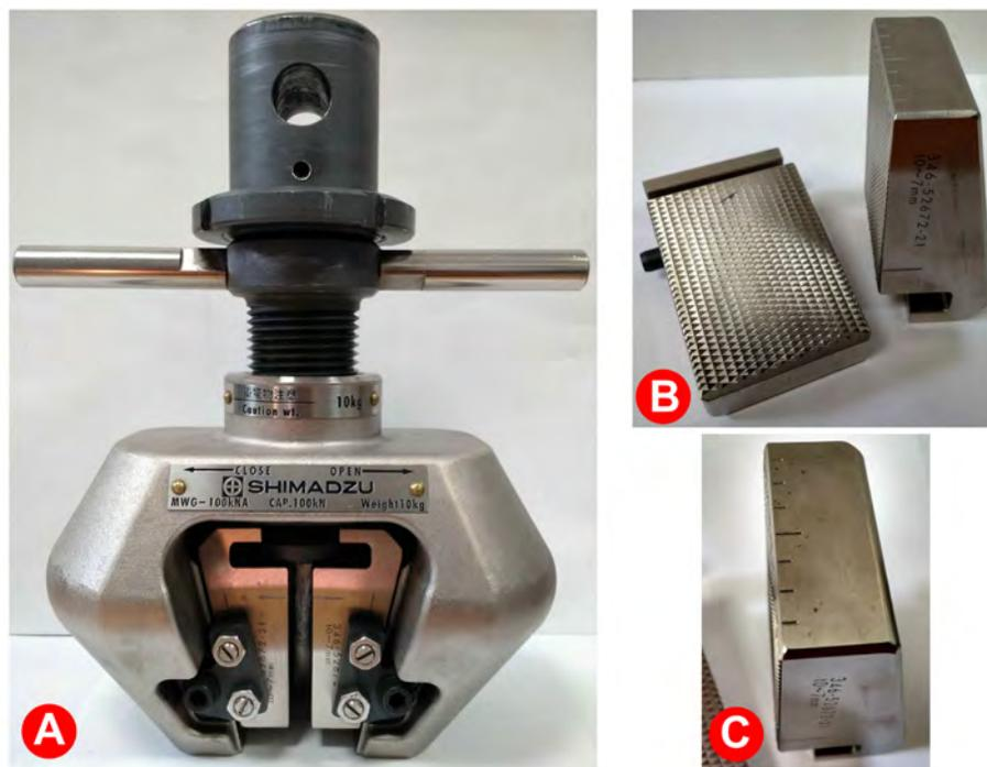
Figura 4.15 Se muestra en A) la mordaza superior de tipo cuña, en B) se indican las dos placas dentadas que utilizan la mordaza superior e inferior y en C) se muestra la placa dentada con el patrón de alineación para la probeta.
