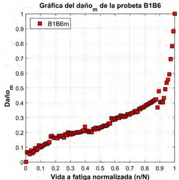
Figura D-5.8 Gráfica del Daño<sub>m</sub> en función de la vida a fatiga normalizada de la probeta B1B6.
