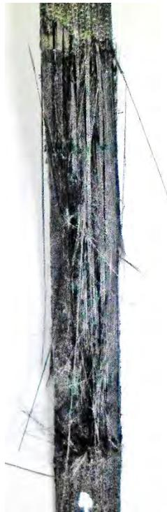
Figura C-5.5 Probeta B1B9 después del ensayo de tensión.
