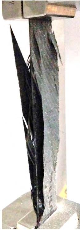
Figura C-2.3 Probeta A3A1 después del ensayo de tensión.
