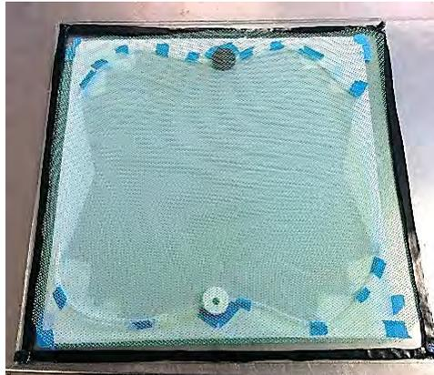
Figura 4.23 Antes de cerrar el sistema se coloca la malla de distribución y se dispone un contorno de cinta de masticaje para adherir la bolsa de vacío con la placa de vidrio.
