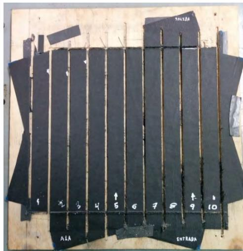
Figura 4.28 Se muestran las probetas 10 probetas (A1A1-A1A10) que se obtuvieron del laminado A1A [0/+15/-15]s.
