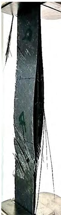
Figura C-7.5 Probeta B3A9 después del ensayo de tensión.
