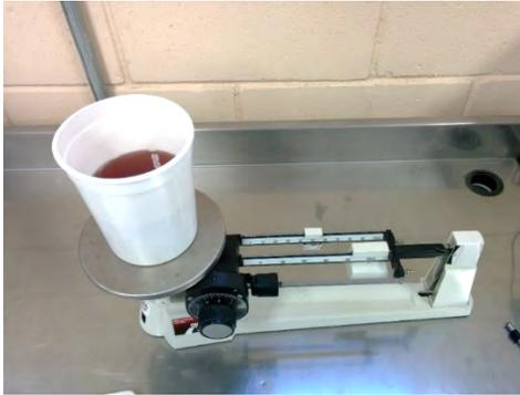
Figura 4.25 Medición de la proporción requerida de resina Polylite® 31424-00.
