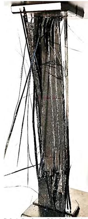
Figura C-9.4 Probeta CIA6 después del ensayo de tensión.
