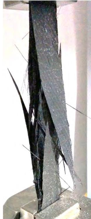
Figura C-2.4 Probeta A3A2 después del ensayo de tensión.
