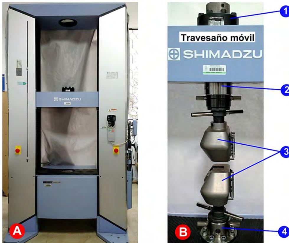
Figura 4.14 Se muestra en A) la máquina de ensayos universales AG-X plus 100 kN y en B) la configuración de la máquina-accesorios para realizar los ensayos de tensión.
