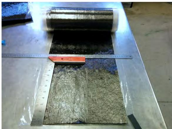
Figura 4.17 Proceso de recorte de las capas de fibras del laminado de estudio.
