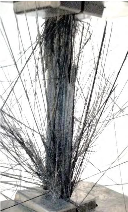
Figura C-4.5 Probeta BIA7 después del ensayo de tensión.
