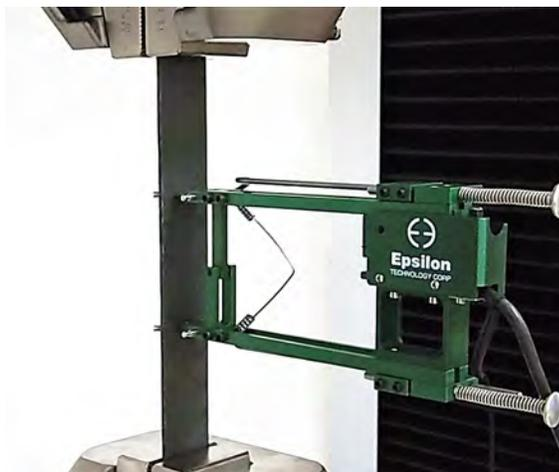
*Figura 4.16 Se muestra al extensómetro axial Epsilon® 3542-050M-050-ST durante el ensayo a tensión de la probeta CIA2.*
