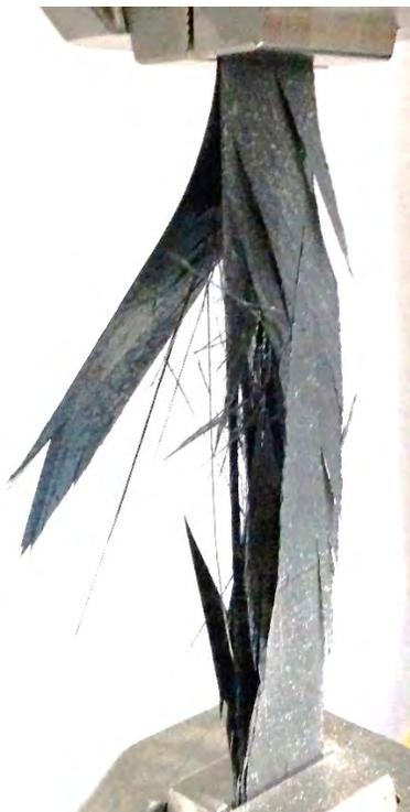
Figura C-2.5 Probeta A3A3 después del ensayo de tensión.
