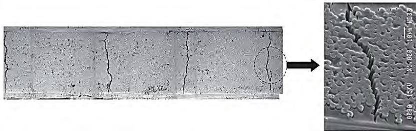
Figura 2.14 Ejemplo de agrietamiento de matriz de un material compuesto laminado cross-ply [12].
