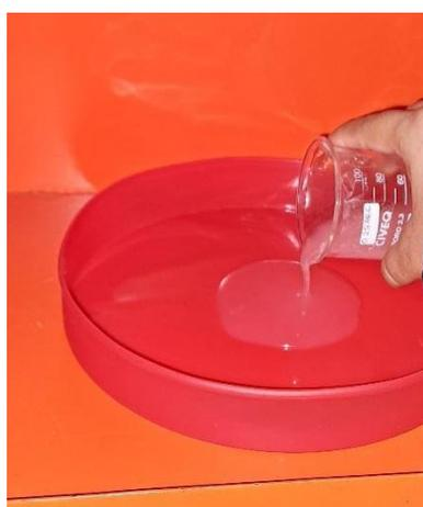
**Figura 24: Vertido de la mezcla en el molde, para el secado.**
