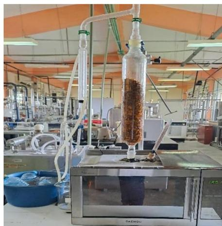
**Figura 17: Extracción del AE.**
