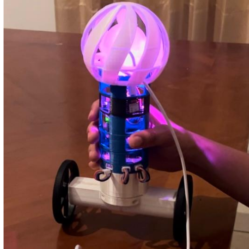
Figura 27: Las primeras pruebas son esenciales para identificar posibles desafíos y ajustes necesarios en el diseño. La imagen puede mostrar la interacción entre el H-TWIP y su entorno, revelando aspectos como estabilidad, respuesta a las entradas de control y posibles áreas de mejora.
