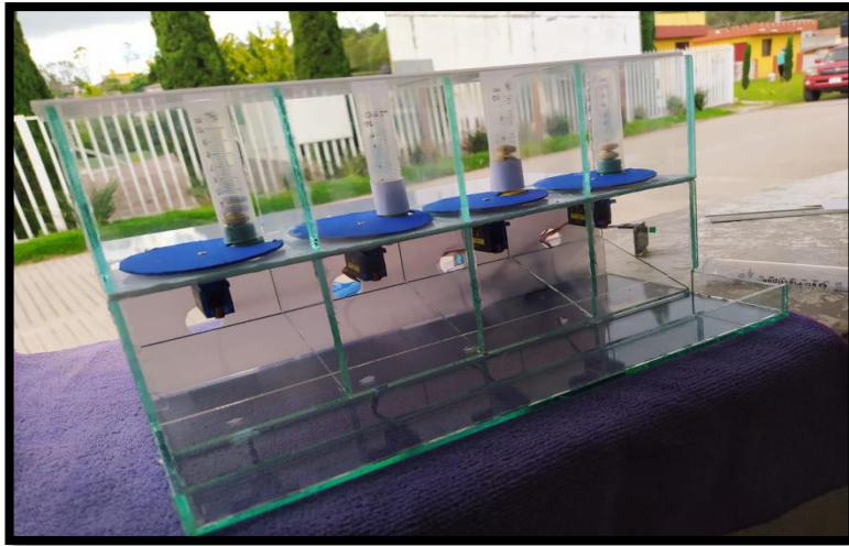
Figura 3.12 Dispensador de medicamento Fuente: Elaboración propia
