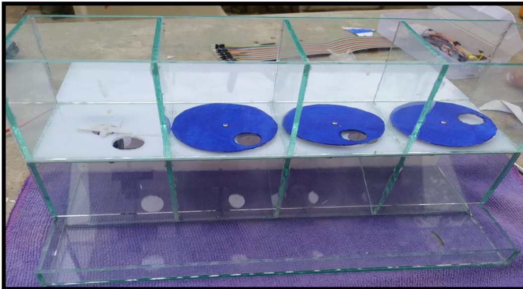
Figura 3.9 Base dispensadoras del medicamento Fuente: Elaboración propia
