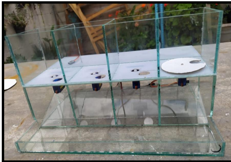
Figura 3.7 Frente del dispensador servomotores colocados Fuente: Elaboración propia
