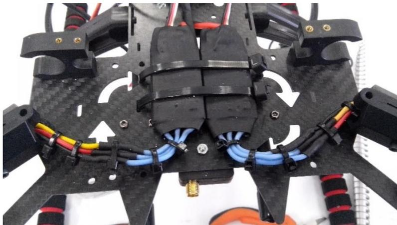
**ILUSTRACIÓN IV-9 IMPLEMENTACIÓN Y ACOPLA DE LOS ESC EN EL CUADRICÓPTERO**
