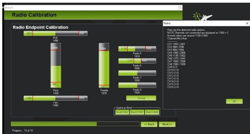
ILUSTRACIÓN IV-19 CALIBRACIÓN DEL RADIO CONTROL EN MISSION PLANNER
