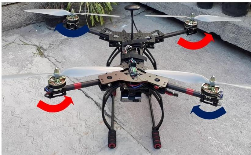
**ILUSTRACIÓN III-3 HÉLICES IMPLEMENTADAS EN EL CUADRICÓPTERO.**
