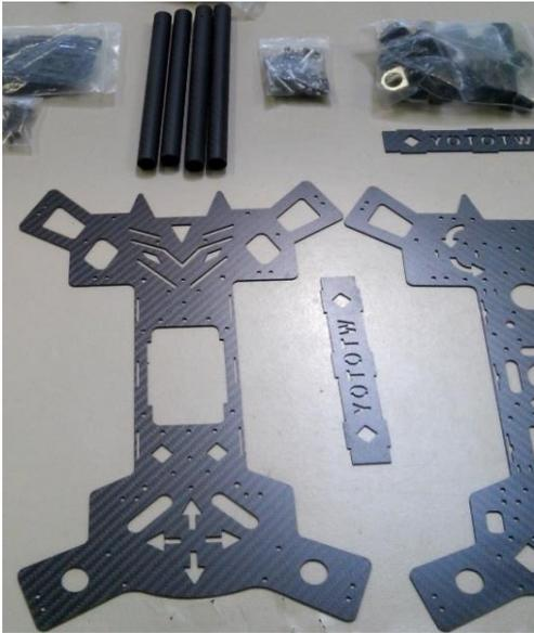
**ILUSTRACIÓN III-2. FRAME IMPLEMENTADO EN EL DRONE DE CUATRO ROTORES**
