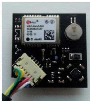
**ILUSTRACIÓN III-15 MODULO GPS Y MAGNETÓMETRO**
