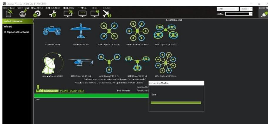
ILUSTRACIÓN IV-17 PANTALLA PARA CARGAR EL FIRMWARE
