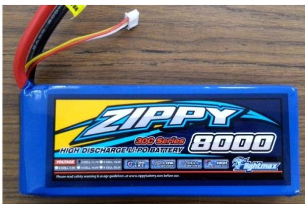
ILUSTRACIÓN III-11 BATERÍA LIPO DE ALTA DESCARGA
