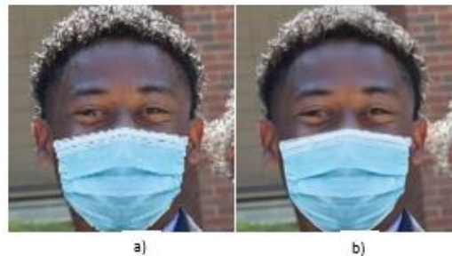
Figura 2.2 Implementación de EDSR. a) Imagen con baja resolución b) Imagen con la implementación de EDSR.
