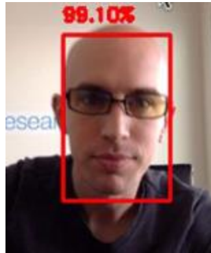
Figura 2.9 Ejemplo de detección de rostro con el detector facial DNN en OpenCv (Rosebrock. 2018)
