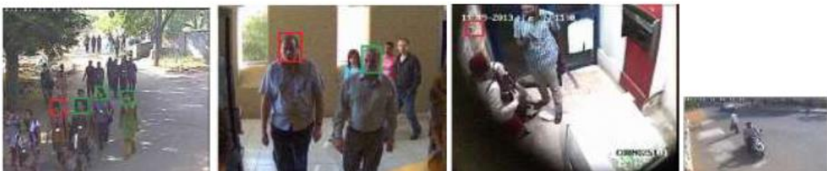
Figura 3.9 Rostros detectados con Yolov2 después de quitar el ruido con desconvolución ciega (Menaka & Yogameena, 2021)
