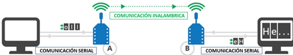
Fig. 2.2 Comunicación XBee-XBee.
