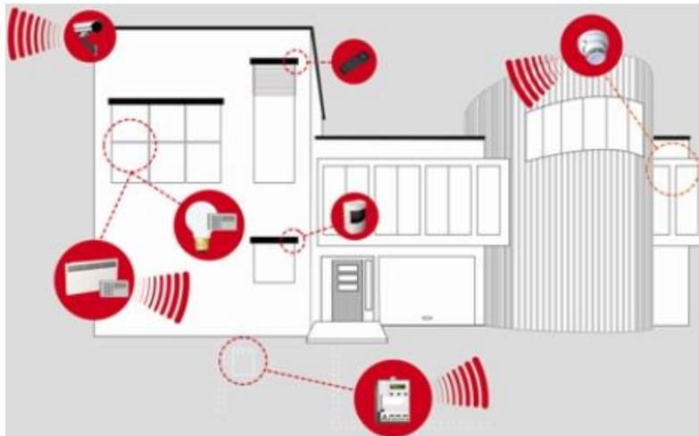
*Fig. 2.4 Aplicación en domótica de ZigBee*
