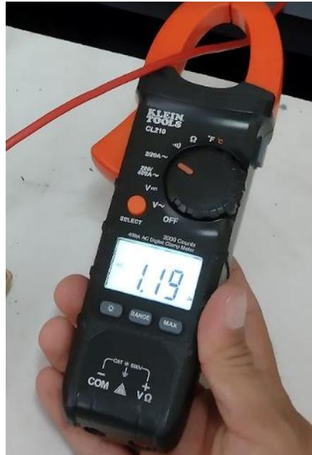
Fig. 4.14 Corriente tomada por amperímetro de efecto Hall
