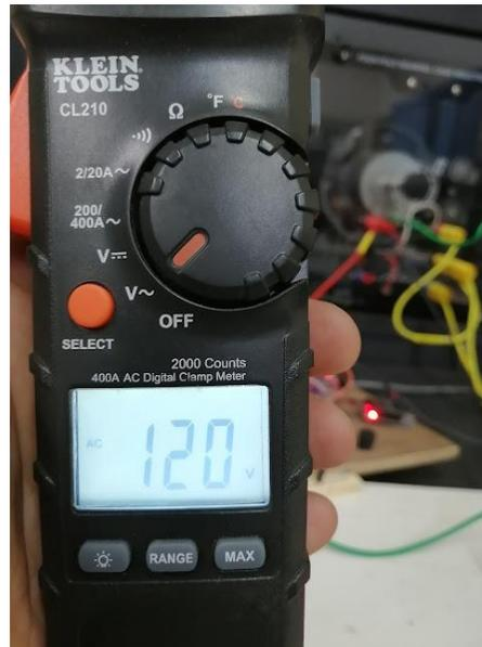
Fig. 4.22 Valores de Voltaje reales con multímetro Klein Tools
