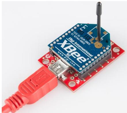
Fig. 2.7 XBee conectado a adaptador Shield.
