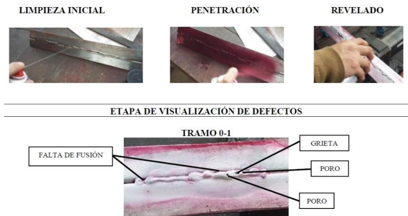
Fig.1.1 Método de líquidos penetrantes [5].
