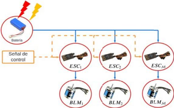
Figura 1.7: Sistema de propulsión.
