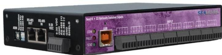
**Fig. 26 Sealevel I/O 430U para entradas**
