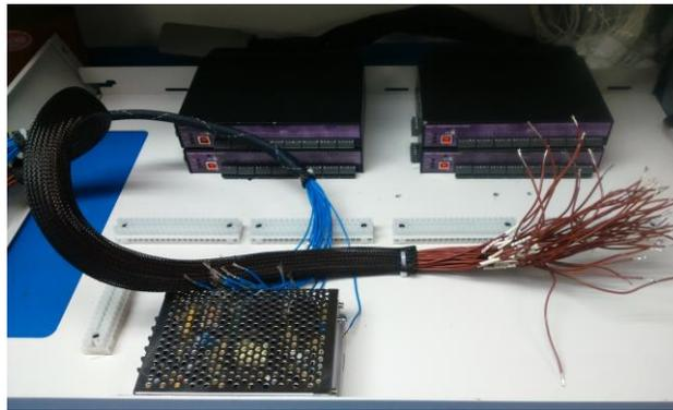
**Fig. 48 Elaboración conexiones Sealevel**
