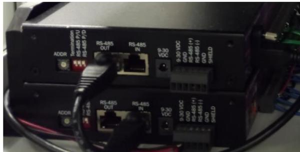
**Fig. 50 Conexión cascada de SeaLevel.**
