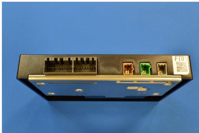
**Fig. 3 Módulo SUBARU DCM**
