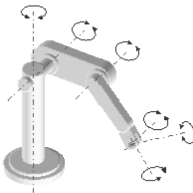
Figura 2.13 Ejemplificación de los grados de libertad en un robot
