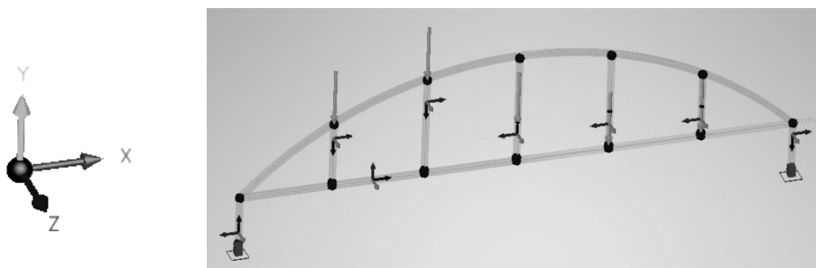
Ilustración 2 Visualización de los grados de libertad presentes en un nodo
