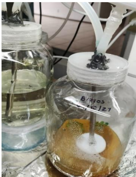
Figura 11. Sistema de inmersión temporal BIT funcional para investigación
