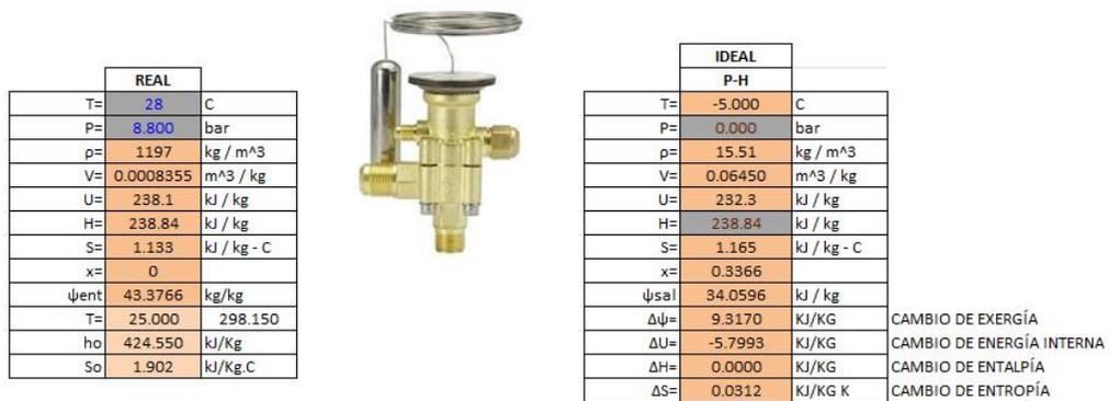
Figura 25. Análisis Exegético de la válvula de expansión 1
