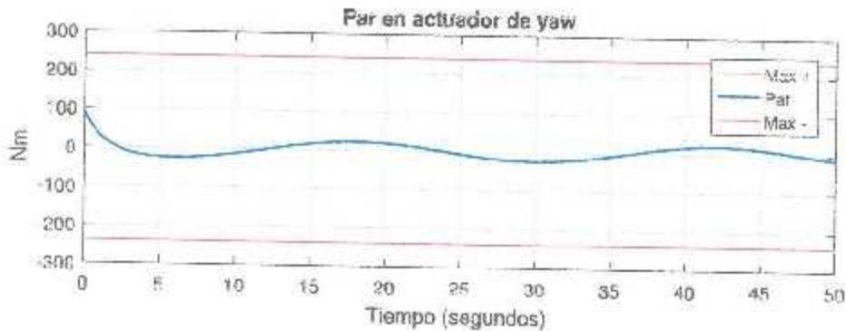
Figura 4.9: Par aplicado para movimiento sinusoidal.
