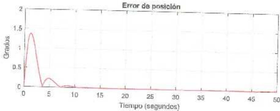
Figura 4.2: Norma del error de posición para movimiento sinusoidal.
