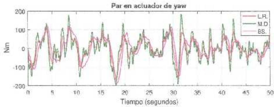
Figura 4.21: Par aplicado para señal de viento generada por TurbSim.
