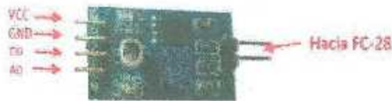
Figura 2.13 Configuración del módulo YL-38[15].
