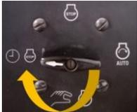
Posicione el selector de encendido en modo AUTOMATICO y la alarma que indica que no esta en automático se apagara.
