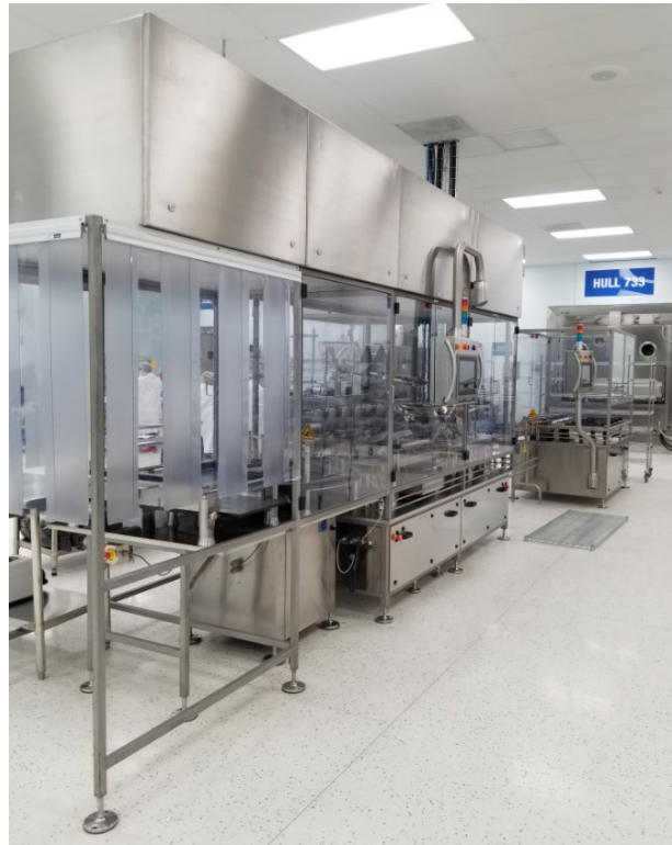
Imagen 2.9. Equipo de llenado automático.
