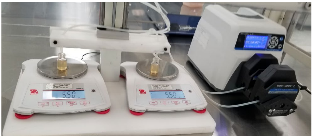
Imagen 2.8. Equipo de llenado manual.
