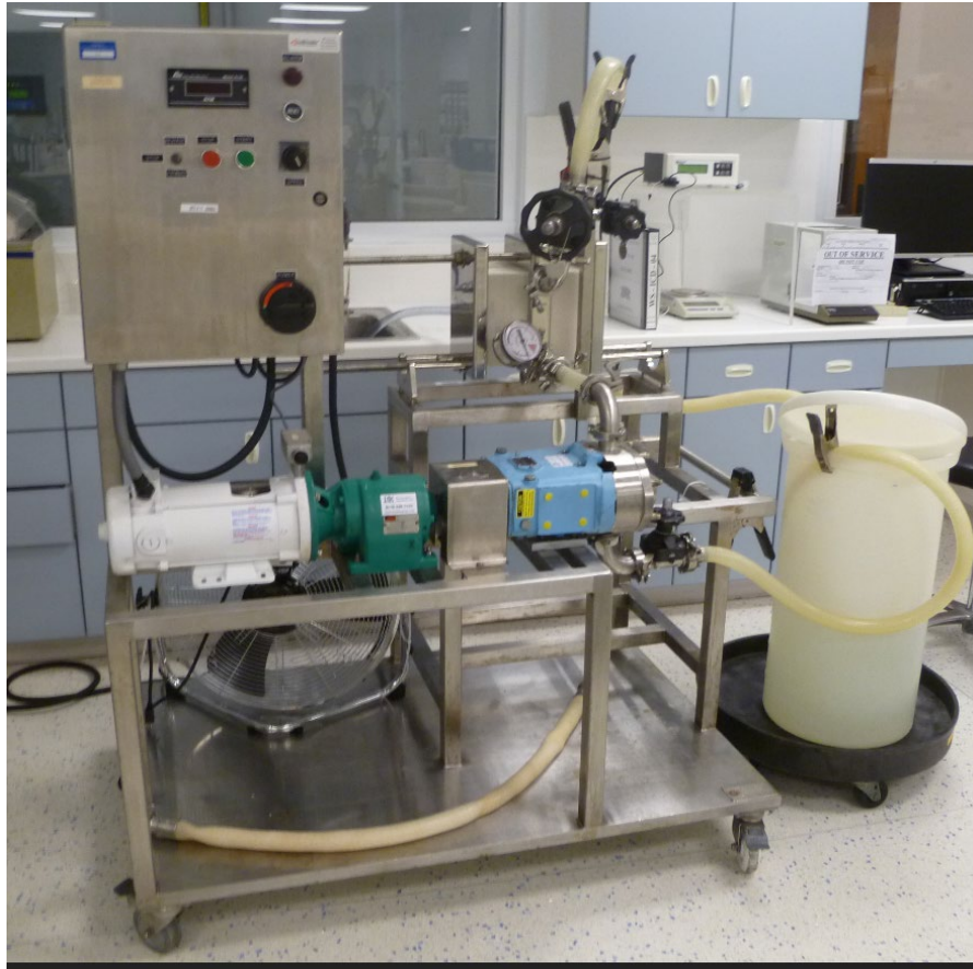
Imagen 2.6. Equipo de ultrafiltración.
