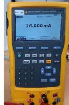
Figura 4.8 B señal de 16 mA enviada por simulador FLUKE
