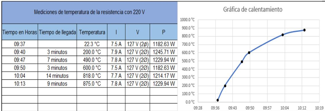
**• PRUEBA NÚMERO 3: CONTROLADOR DE TEMPERATURA Y RESISTENCIA CALEFACTORA**
