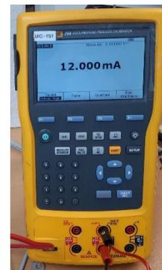
Figura 4.7 B señal de 12 mA enviada por simulador FLUKE
