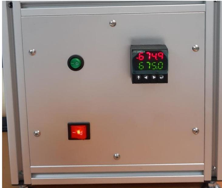
Figura, botones de control y controlador de temperatura
