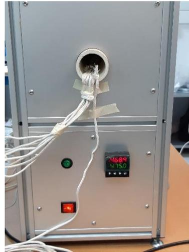
**Figura 4.12** Caracterización del horno, en el primer punto 475 °C
