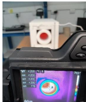
Figura 4.3 Cámara termográfica FLIR T440
