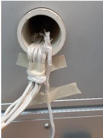
**Figura 4.11** Colocación de los sensores dentro de la cavidad del horno
