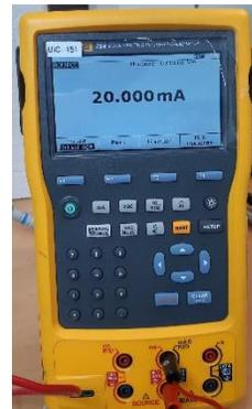
Figura 4.9 B señal de 20 mA enviada por simulador FLUKE
