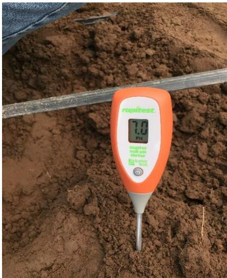
Figura 2. Medidor digital de pH del suelo
