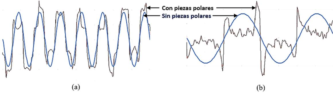
Figura 3.7. Efectos de la modulación. Formas de onda de la densidad de flujo axial con respecto a la posición angular mecánica, sin piezas polares (no moduladas) y con piezas polares (moduladas) debidas a ambos rotores de imanes permanentes: (a) En el entrehierro de baja velocidad con armónico fundamental de orden  $p_l = 7$ . (b) En el entrehierro de alta velocidad con armónico fundamental de orden  $p_h = 2$ .
