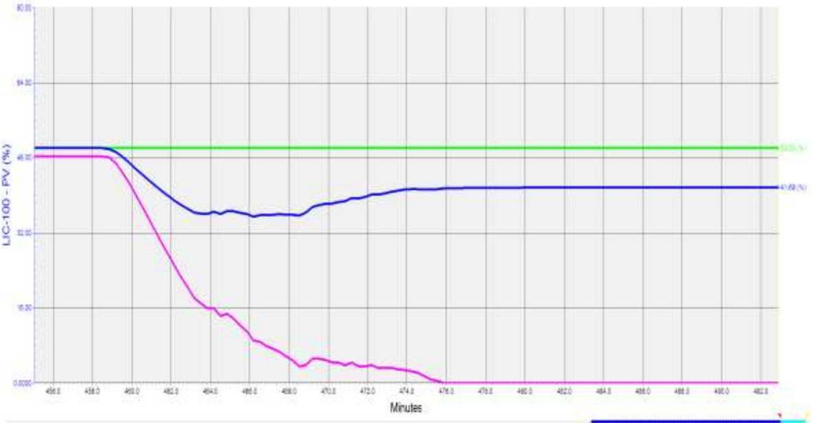
Figura 4.25. Comportamiento de VP y OP del lazo de control de nivel del fondo de la torre cuando falla la bomba P-03 A.B.
