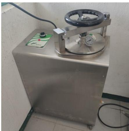
*Figura 1.1.5. Autoclave utilizada para la esterilización de medio de cultivo y herramientas de trabajo*
