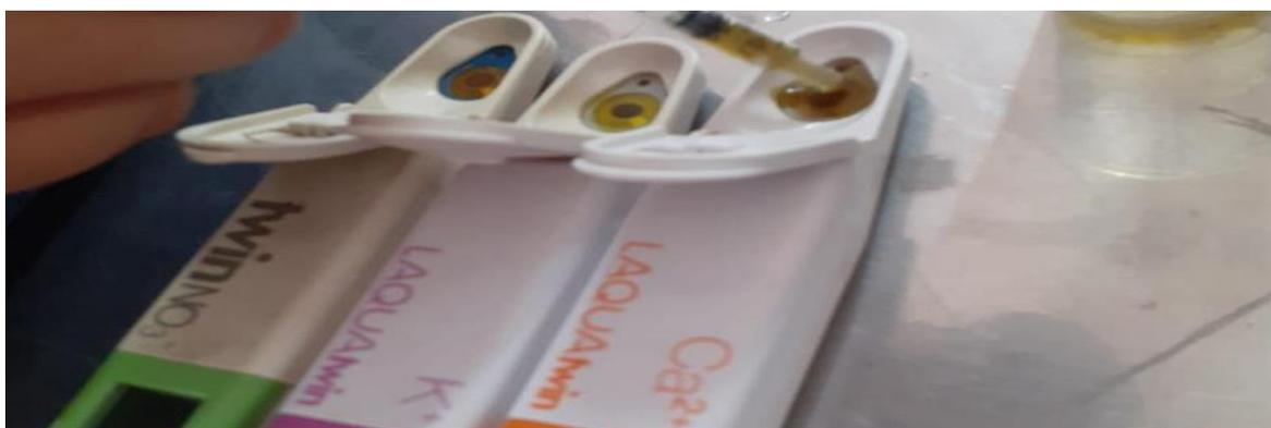
**Figura 28.** Ionometro utilizado para la toma de nitrato, calcio y potasio.
