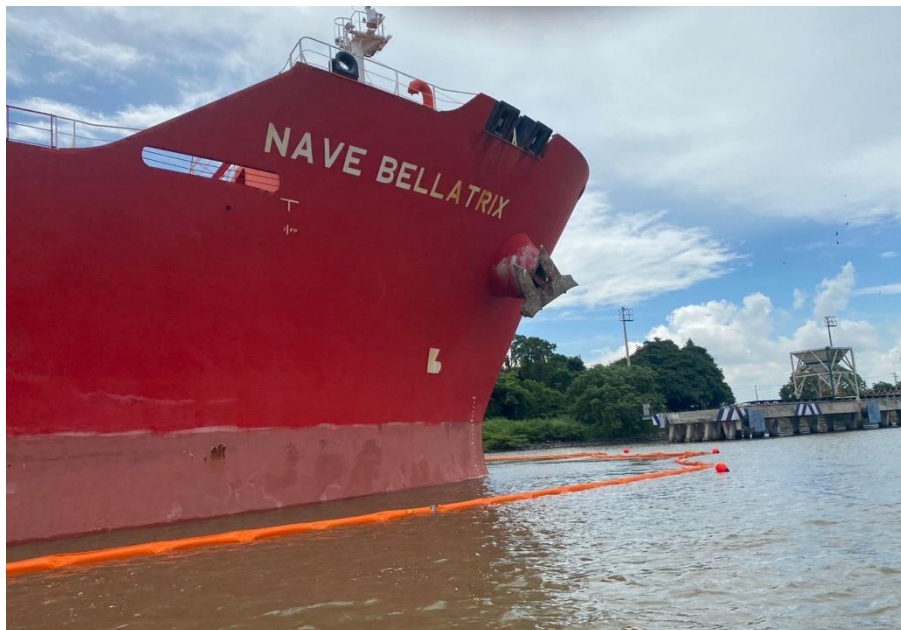
Figura 31. Termino de instalación de barreras y equipo
