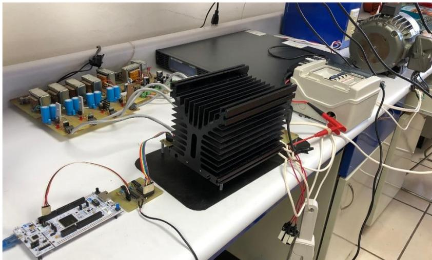
Figura 5. 17. Inversor trifásico en conjunto con el motor de inducción de 1 hp
