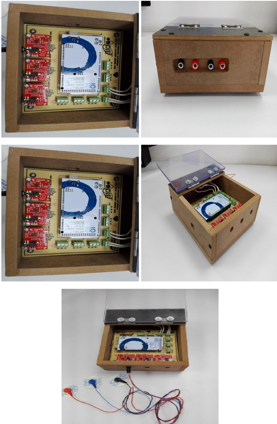
Figura 6.5: Implementación del sistema de adquisición de señales eléctricas
