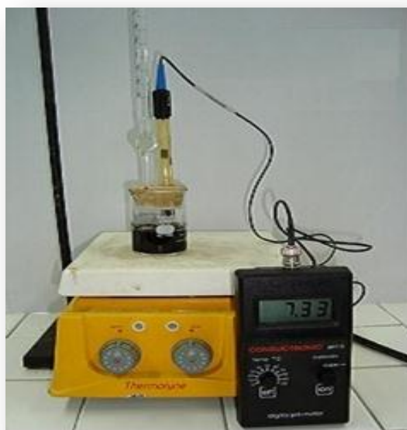
Figura 2.4. Sistema instrumental para la titulación potenciométrica con n -butilamina.
