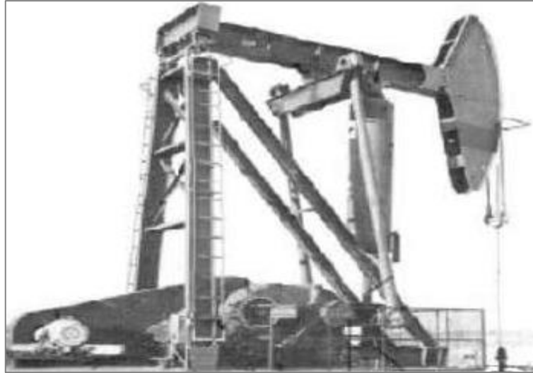
Figura 2.10 Unidad aerobalanceada (UNAM, “Apuntes de sistemas artificiales de producción”2009).
