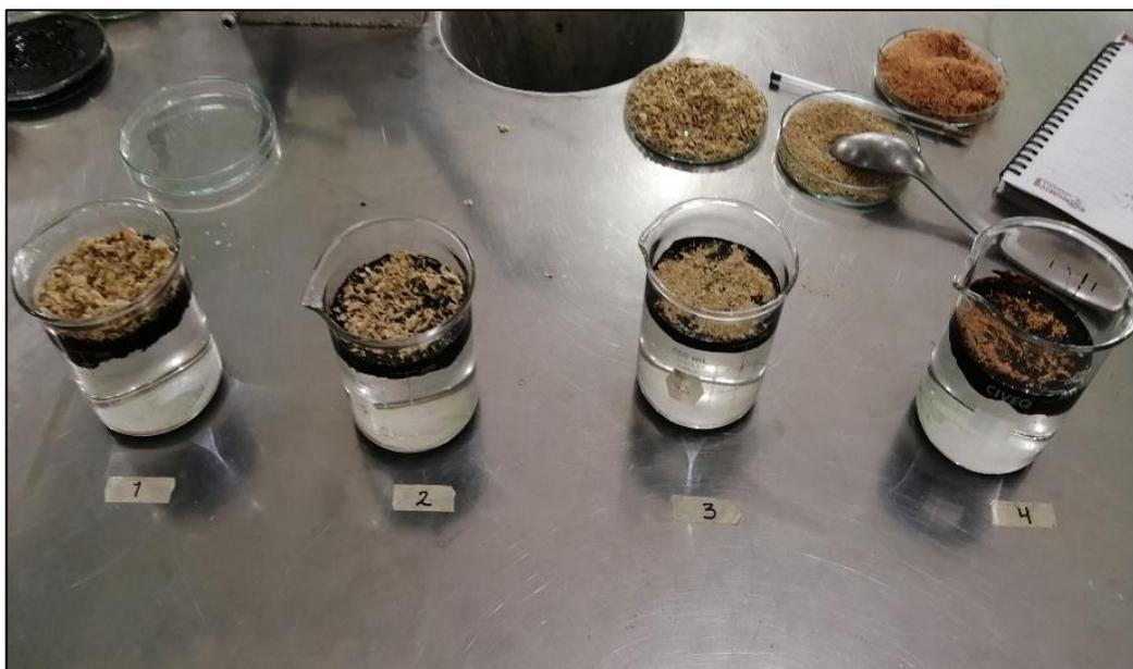
Figura 4.2 Absorción de petróleo con olote y aserrín.
