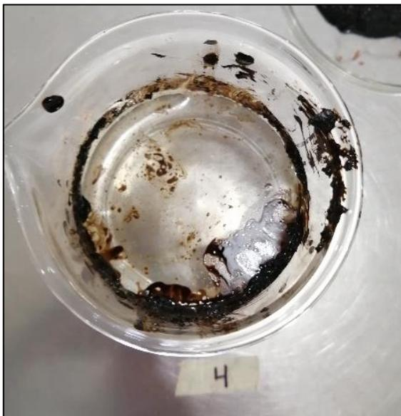
Figura 3.31 Resultado de la absorción con aserrín.
