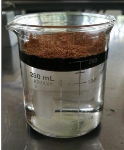
Figura 3.29 Prueba con Aserrín en agua dulce.
