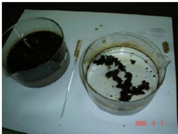
Figura 2.12 Reacción del hidrocarburo cuando se le aplica PBF
