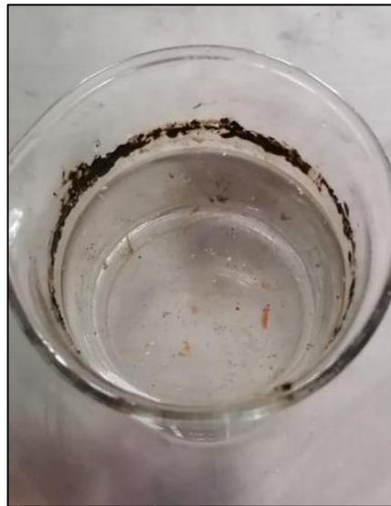
Figura 3.34 Resultado de la absorción del aserrín en agua salada.
