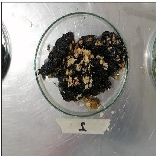
Figura 3.16 Absorción del olote con la muestra 2.
