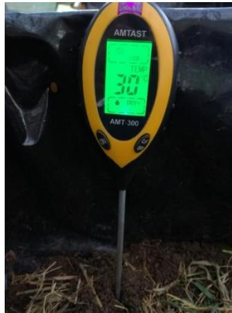
Figura 3.12 Obtención de temperatura con un multiparamétrico marca AMSTAST.
