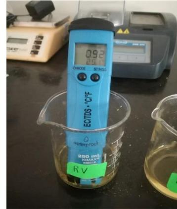
Figura 3.21 Medición de CE en lixiviado.
