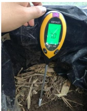
Figura 3.11 Obtención de pH con multiparamétrico marca AMSTAST.
