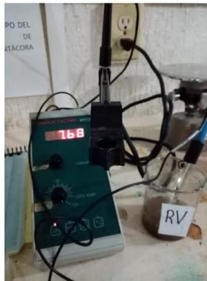
Figura 3.16 Medición de pH.
