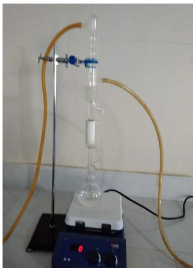
Fig.7: Modificación química del bambú
