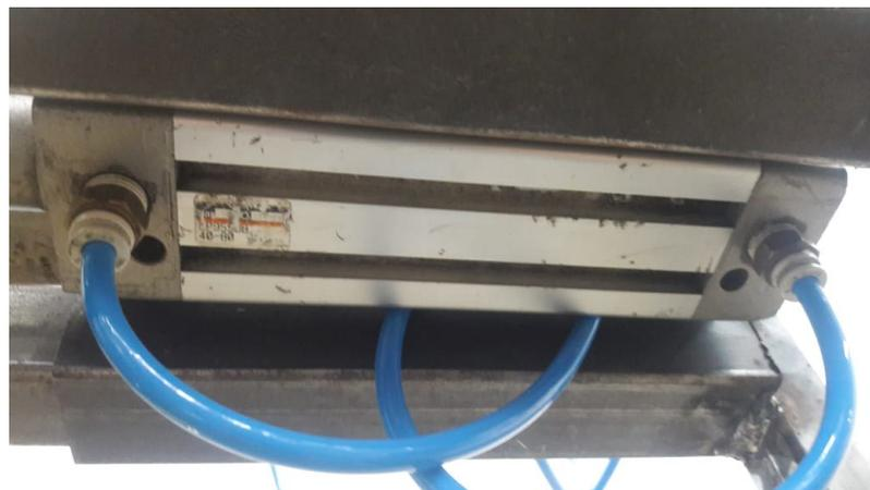
Figura 3.15: Piston SMC modelo CP95P.
