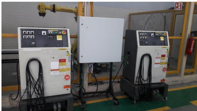
Figura 4.5 Gabinete con controladores de los robots.
