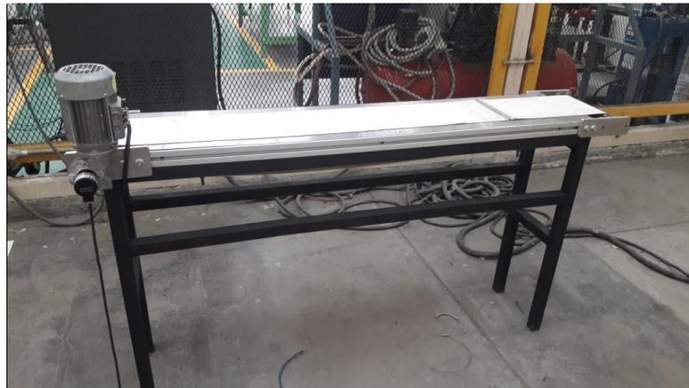
Figura 3.19: Banda transportadora.
