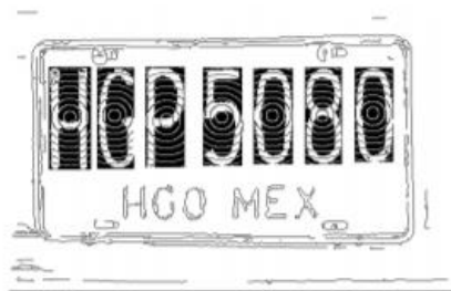
Figura 2.5 Reconocimiento de caracteres de una placa mediante visión artificial [22].
