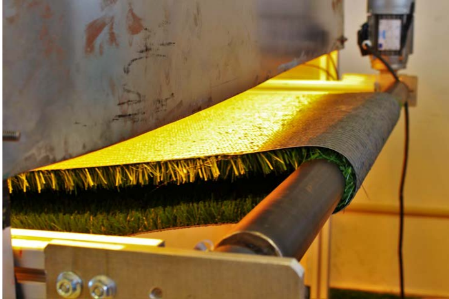
Figura 4.6. Banda de tapete de pasto sintético en rodillo sobre el eje del motor.
