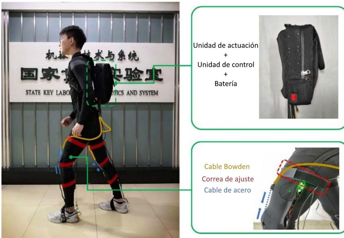
Fig. 2-15 Exotraje diseñado por Zhao para asistir el ascenso de escaleras [24].
