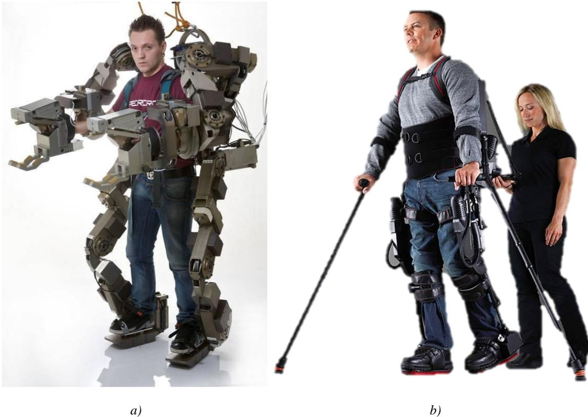
*Fig. 1-1 Exoesqueleto para a) aumento de potencia y b) para rehabilitación y/o asistencia [9], [11].*
