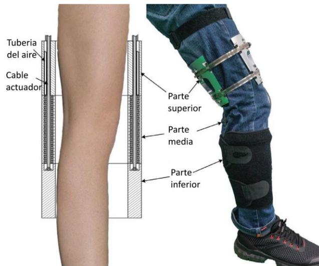
Fig. 2-11 Exoesqueleto flexible diseñado por Xie et al. [57].
