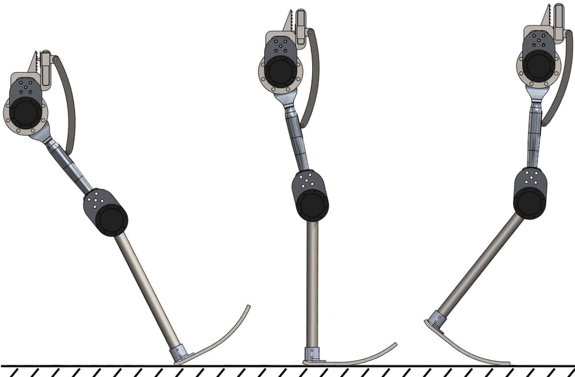
Fig. 4-46 EMI en el contacto inicial (izquierda), apoyo medio (centro) y apoyo terminal (derecha).
