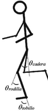
Fig. 3-2 Diagrama mostrando los grados de libertad de la cadera, rodilla y tobillo en el plano sagital [40].
