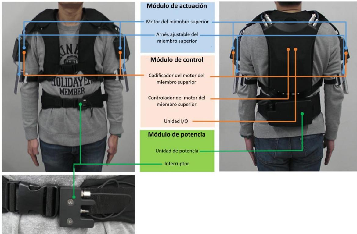
Fig. 2-6 Exoesqueleto para estimular miembros superiores diseñado por Yap et al. [22].
