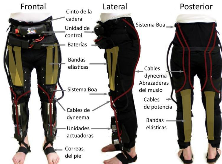
Fig. 2-12 Exoesqueleto con tendón artificial biarticular [58].
