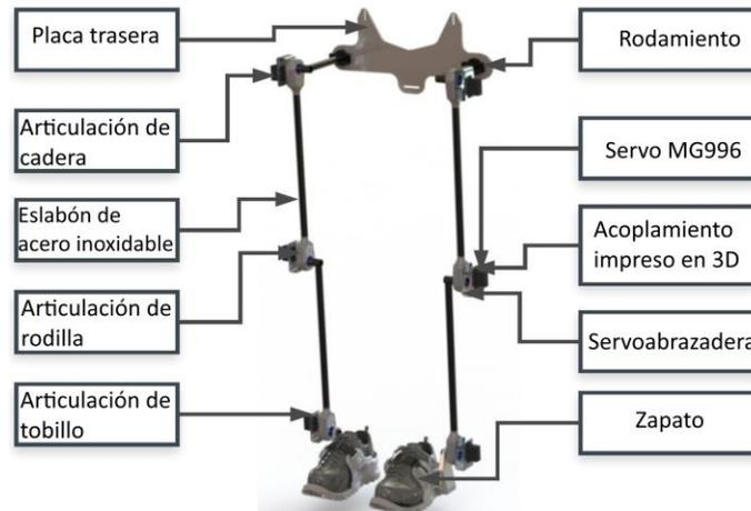
Fig. 2-2 Exoesqueleto de miembro inferior pasivo de cuatro grados de libertad [46].
