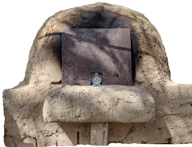
Figura 19: Imagen de la colocación del termómetro en la puerta del horno. Fuente: Propia.
