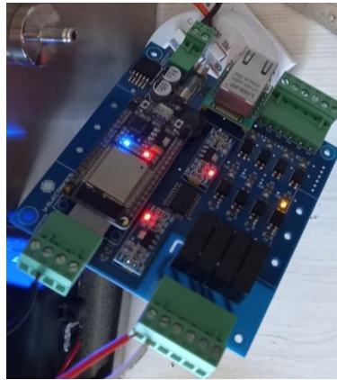
Imagen 41 Tarjeta ESP32 conectada a la tarjeta PLC
