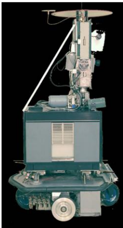
Fig.1 El robot móvil con ruedas Shakey de SRI que está equipado con lógica integrada, una cámara, un sensor de telémetro y un detector de impacto.
