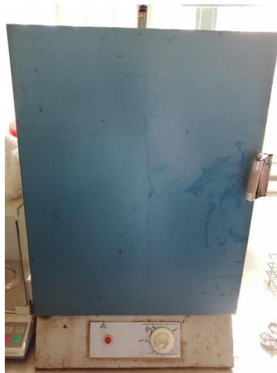
Figura 16. Estufa para determinación de humedad por pérdida de peso (Fuente propia).
