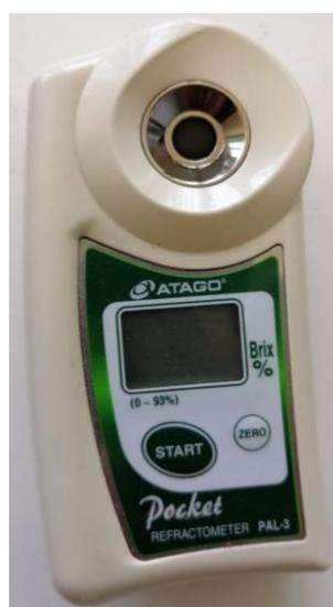
Figura 20. Refractómetro (Fuente propia).
