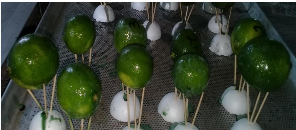
Limones con inulina en secado después de salir del sistema de inmersión con sonificador.
