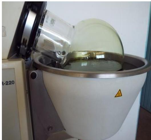
Figura 19 Proceso de reducción del jugo de alfalfa macerada, el etanol y agua se evaporan por temperatura, movimiento y presión de succión.
