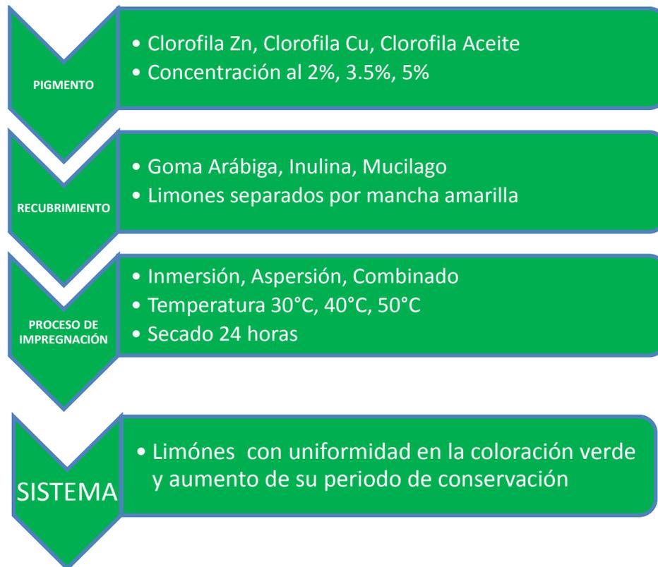
Figura 28. Diagrama de flujo del Sistema de Impregnación del limón
