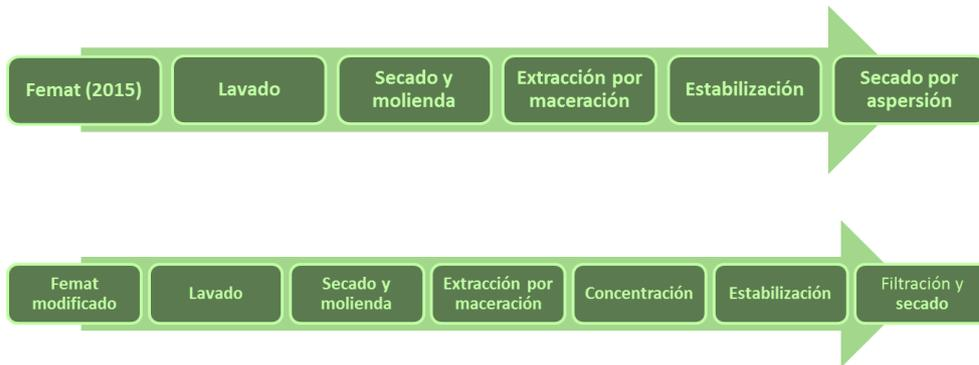
Figura 14 Diagrama de flujo que muestra la modificación al proceso de obtención de clorofila al método de Femar en el 2005.
