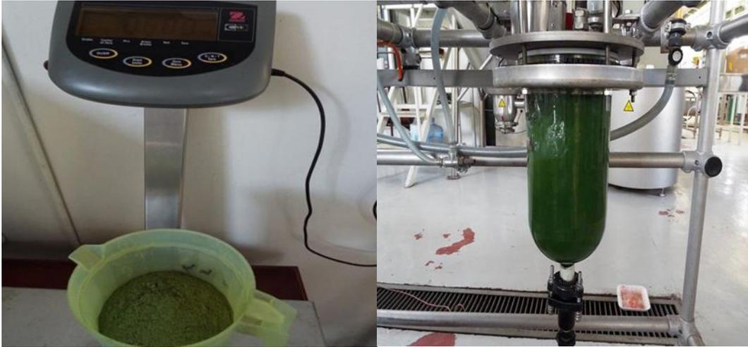
Figura 18 Alfalfa pulverizada en constante movimiento, impulsada por una propela interna.
