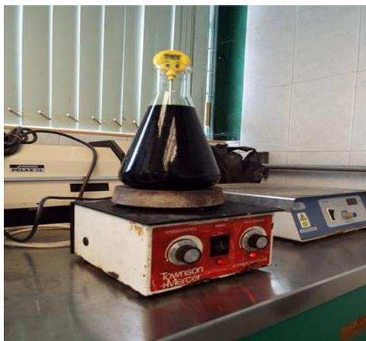
Figura 21 Apariencia de la solución de clorofila líquida ajustada con sulfato de cobre. Lista para el precipitado y separación del sedimento
