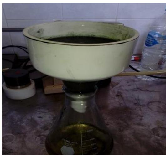
Figura 22 Sedimento de clorofila en el proceso de lavado por succión de vacío.
