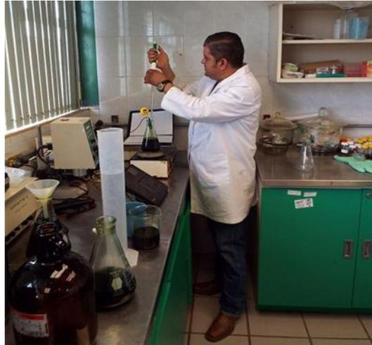
Figura 20 Ajuste de la solución a pH 12 y pH 2.7 demanda manipular calentador, termómetro, pH metro, solución en movimiento y pipeta
