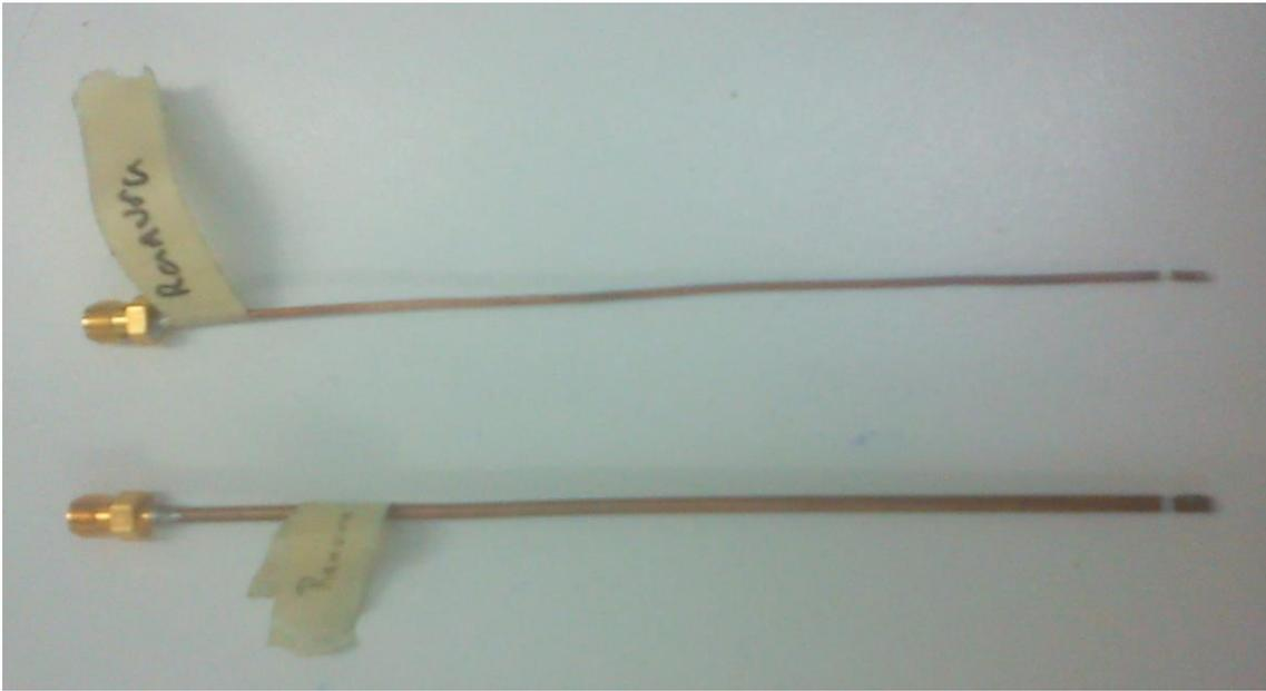
Figura 5.10. Aplicadores UT-85 y UT-47 de una ranura ya terminados
