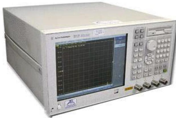
Figura 5.21 Analizador de redes Agilent E5071B ENA
