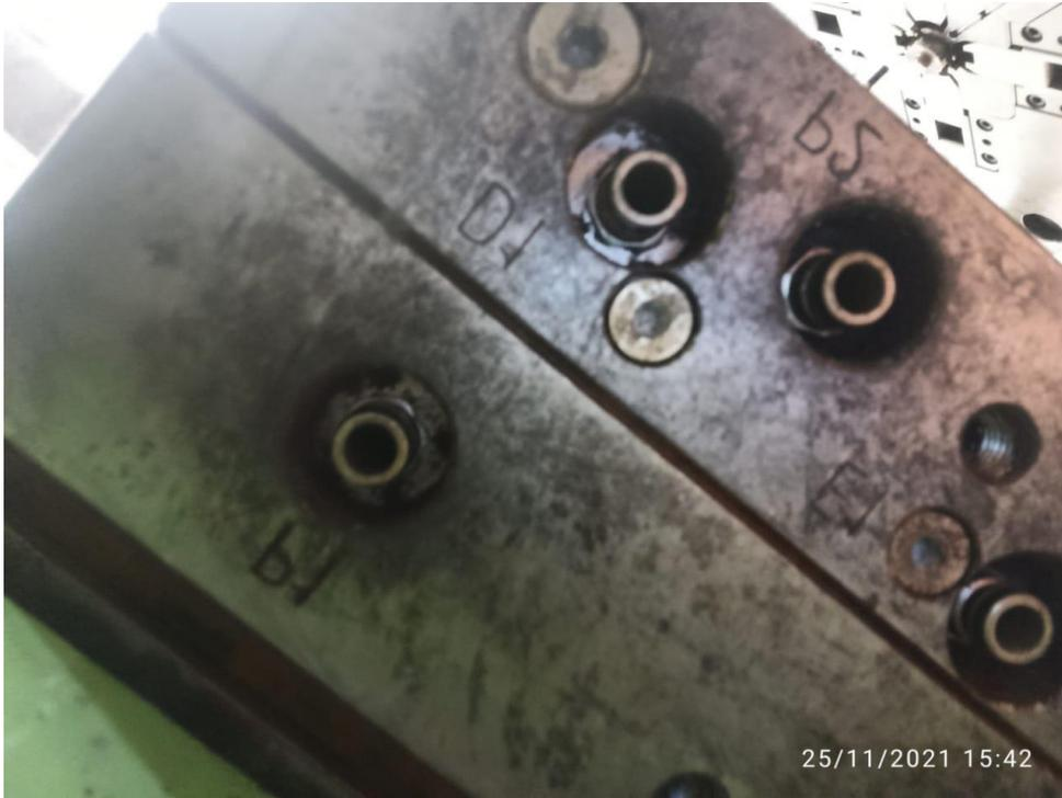
*Ilustración 18 conexiones de refrigeración en la parte debajo del molde*
