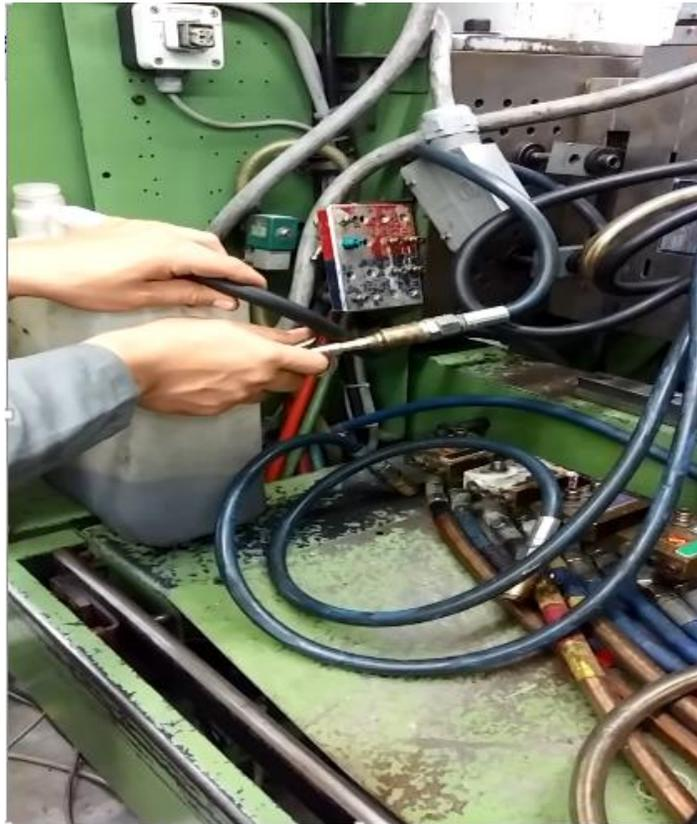
*Ilustración 16 Purgado de un molde.*
