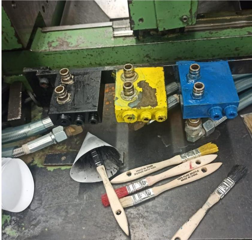
*Ilustración 40 Manifolds en el proceso de la mejora.*
