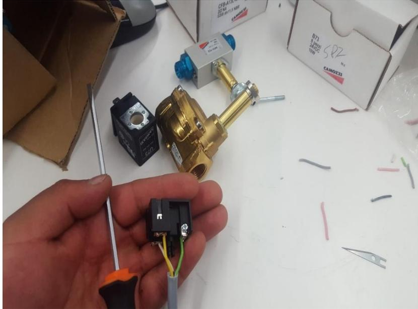
*Ilustración 33 conexiones de electroválvulas*
