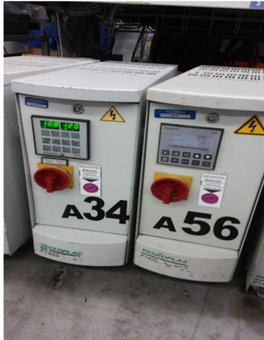
*Ilustración 13 Termostatores configurados a 120°C*
