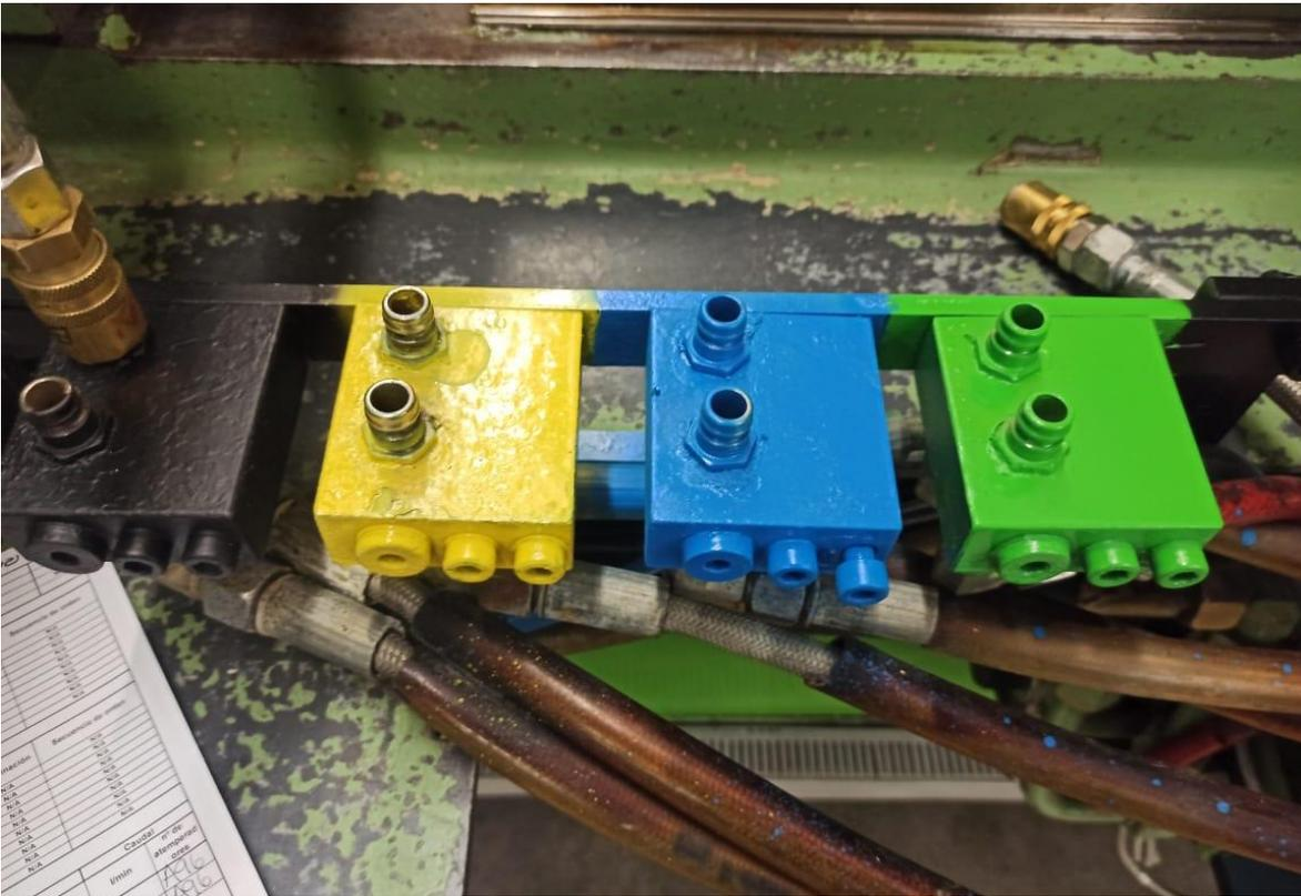
Ilustración 41 Mejora terminada en los manifolds.
