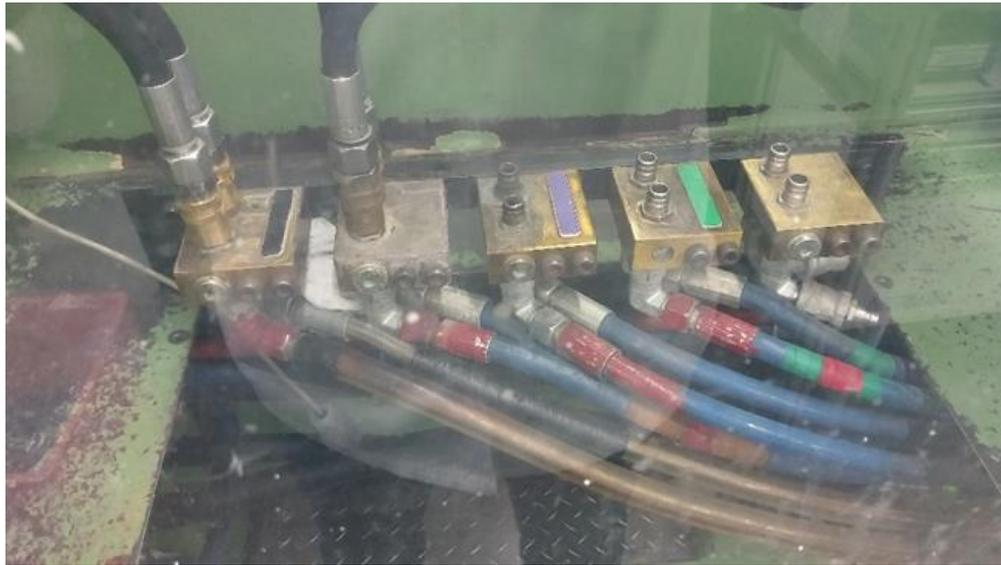
*Ilustración 14 Conexiones de mangueras desde los termostatos a los manifolds.*
