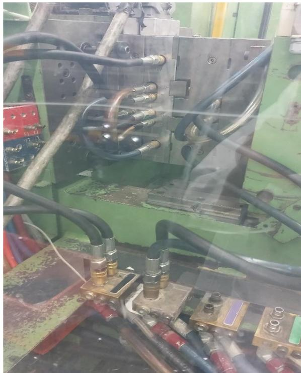
*Ilustración 15 Conexiones de mangueras de los manifolds hacia el molde a refrigerar.*
