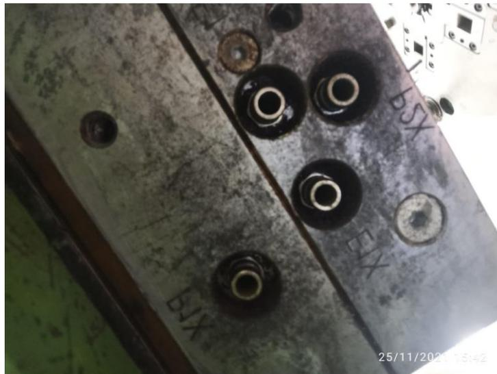
*Ilustración 17 conexiones de refrigeración en la parte debajo del molde*
