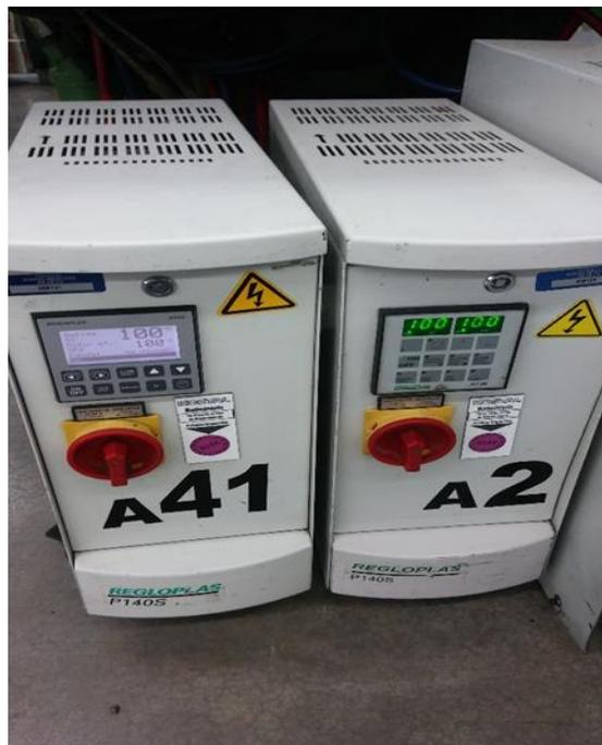
*Ilustración 12 Termostatos configurados a 100°C*
